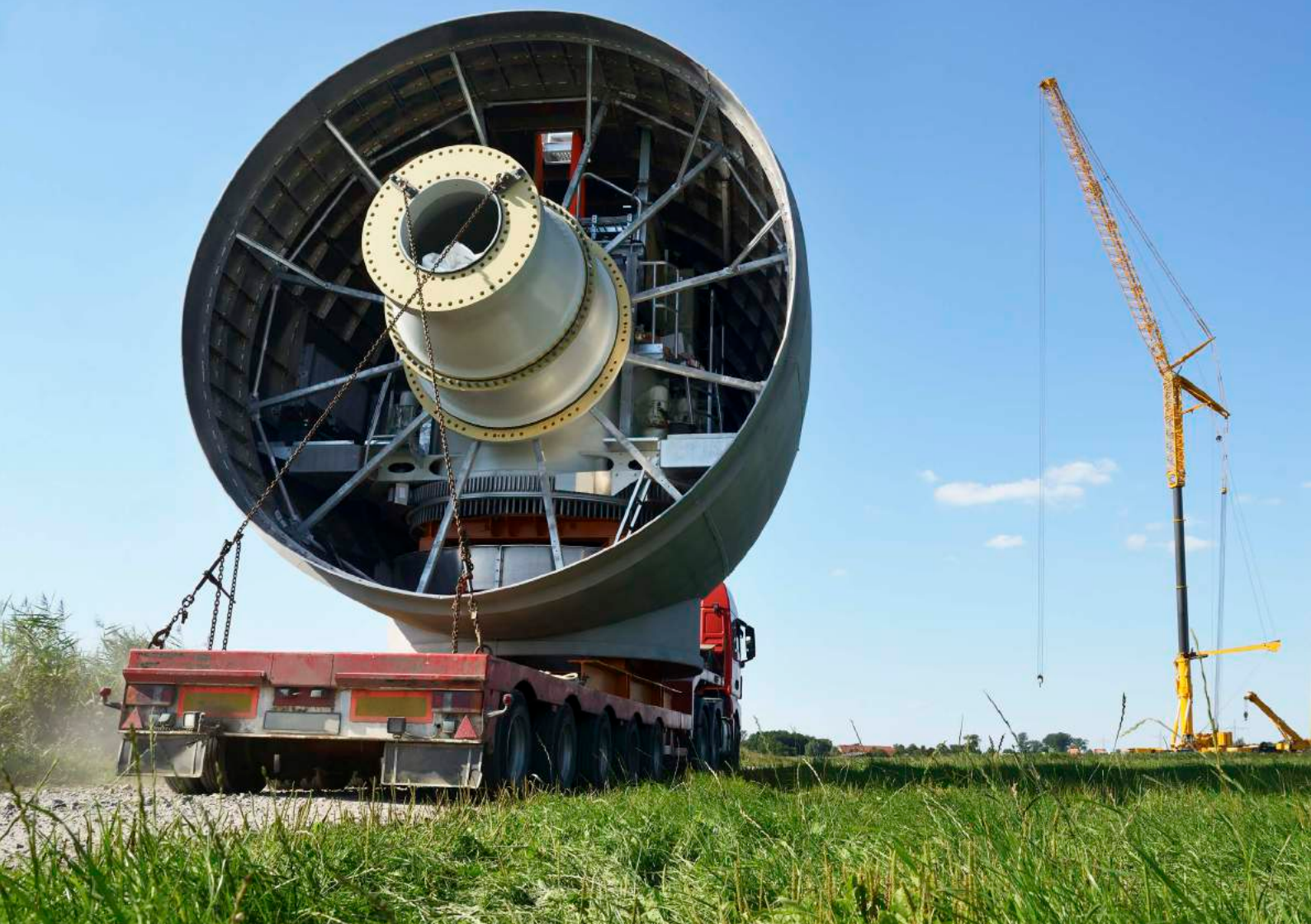
Transporte do cubo até o local de montagem da turbina.
