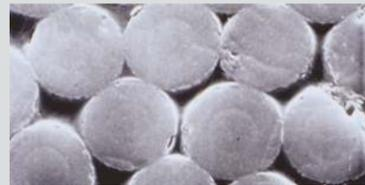
**Fibras de Carbono nas Lâminas de PRFC**
