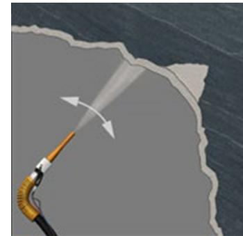
Fig. 7.3: 1ª camada de concreto projetado - 1ª estabilização da escavação e ponte de aderência para a 2ª camada de concreto projetado
