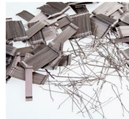
Fig. 4.7: Fibras de aço para melhoria da absorção de energia do concreto
