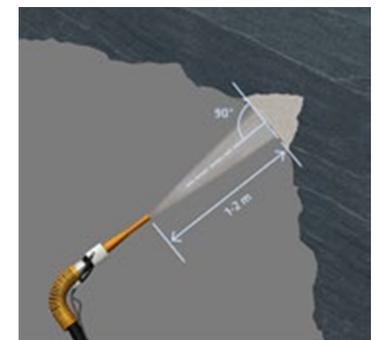
Fig. 7.6: Correta manipulação do mangote - ar demasiado causa reflexão e um elevado volume de projeção causa laminação
