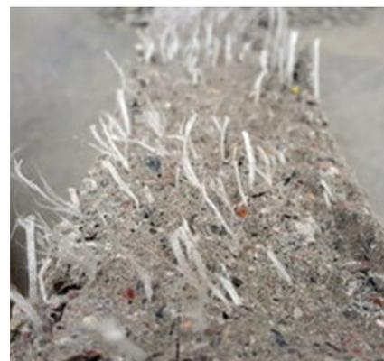
Fig. 4.6: Fibras de PP distribuídas uniformemente em uma amostra de teste de projeção rampada.
