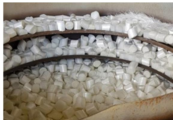
Fig. 4.8: Fibras SikaFiber® Force-60 PP dosadas automaticamente na produção de concreto projetado como discos envoltos por filme hidrossolúvel.
