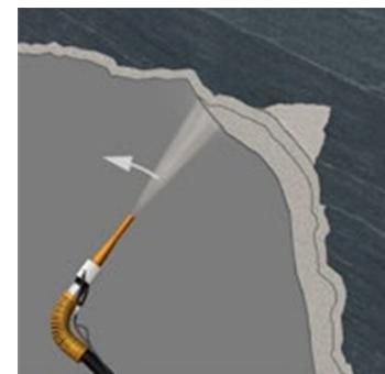
Fig. 7.5: 2ª camada de concreto projetado - estabilização da escavação, usualmente junta com armadura de aço
