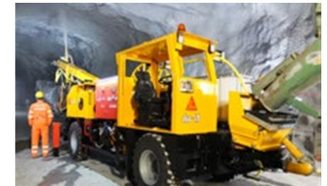
Fig. 6.6: Aliva®-520 - Sistema de projeção para concreto
