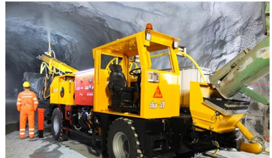
Fig 1.3: Aplicação de concreto projetado, alto grau de mecanização
