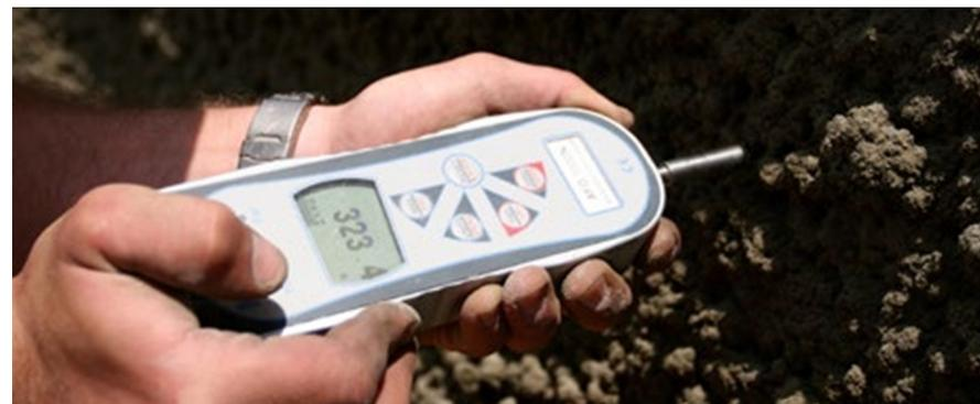
Fig. 8.3: Penetração em concreto recém projetado usando um penetrômetro digital (Mecmesin AFG 1000)
