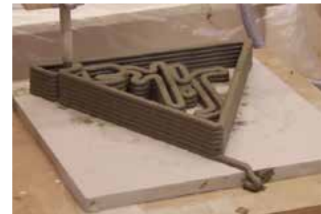
Figura 2: Combinação de um braço robótico com o sistema MiniShot; Logotipo da Sika em 3D
