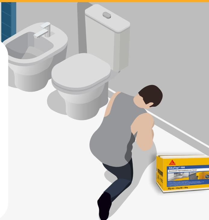
**2. Molhar a regularização** por três dias e após a cura, aplicar sobre ela 3 demãos cruzadas e alternadas de **SikaTop®** aguardando sempre a secagem da camada anterior.
