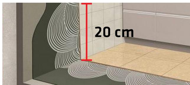
3. Após três dias da última demão de **SikaTop®**, assentar diretamente o material de acabamento utilizando a argamassa colante **Sika® Ceram-300**. Para melhorar a aderência e a resistência do rejunte, indicamos a utilização da cola especial **Sika® Chapisco Plus**.
