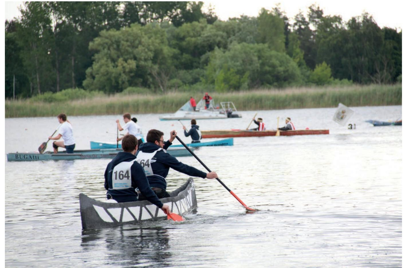
O formato da canoa, tradicional, vem de um modelo em 3D preexistente, baixado da internet. Uma impressora 3D deu forma ao molde vazado em malha plástica reforçada.
