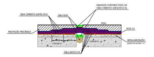
OBS 1 : PARA QUE O SELANTE TENHA A EFICIÊNCIA ESPERADA A JUNTA DE DILATAÇÃO DEVE RESPEITAR A PROPORÇÃO DE ALTURA x LARGURA DE 1:2.
