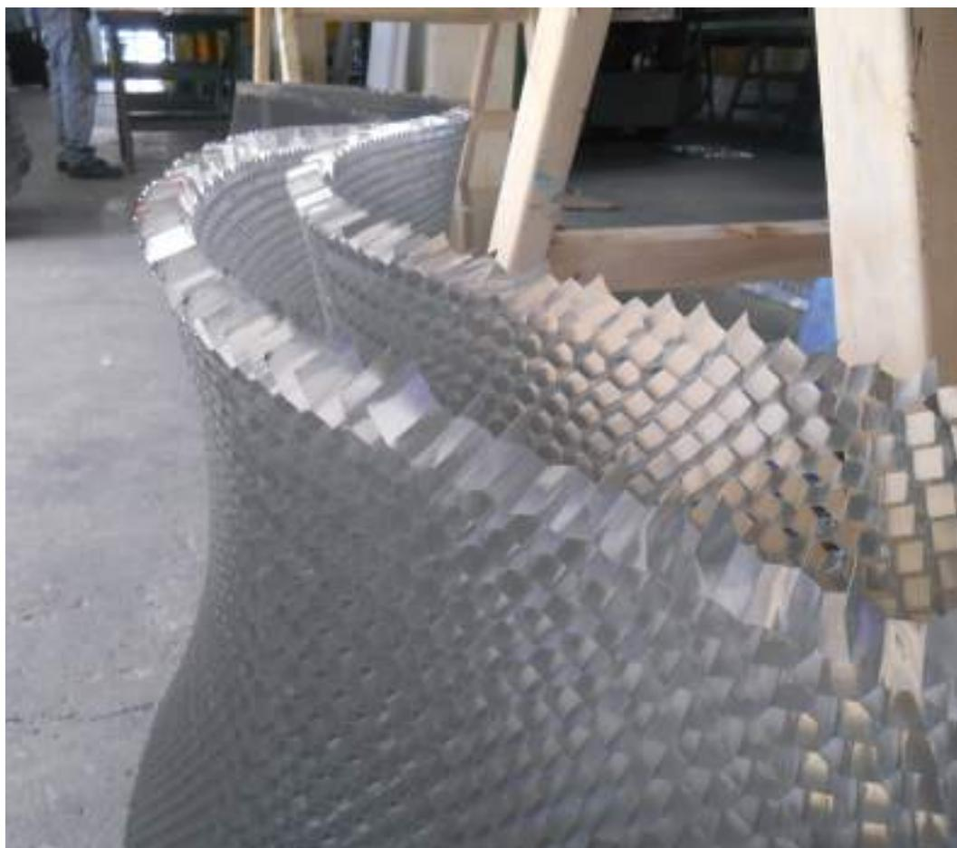
Painéis honeycomb podem ser usados em instalações de grandes dimensões, têm excelente rigidez e nivelamento, e reduzem o peso da estrutura.
