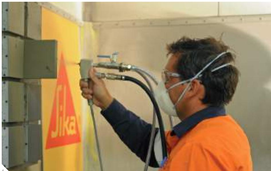
sistema laboratorial MiniShot da Sika, pela primeira vez tornou-se possível simular de maneira realista – mas em miniatura, como o nome sugere – tanto a composição dos componentes do concreto quanto seu processo de mistura no bico do jateador.
