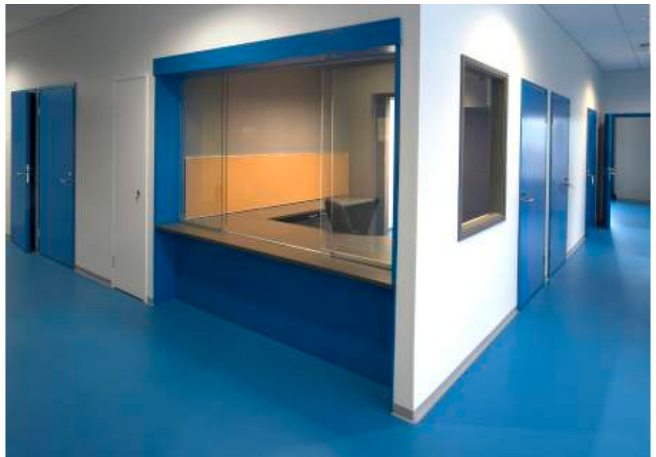
As paredes dos lavatórios e áreas comuns foram tratadas com SikaGard® Hygienic, um revestimento livre de emendas – uma novidade para a Finlândia.
