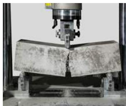
Ensaio de viga: EN 14651
