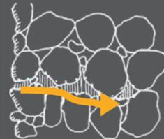
Na **FORMAÇÃO DE ZONA DE PENETRAÇÃO**, o excesso de pressão do slurry é transferido para o esqueleto do solo ao longo de toda a profundidade de penetração, por meio de tensões de cisalhamento entre a suspensão e os grãos do solo em solos de permeabilidade moderada a alta. O slurry penetra nos poros do solo antes de parar e endurecer, constituindo a interface impermeável. Esta zona varia de algumas dezenas de centímetros até alguns metros de espessura.
