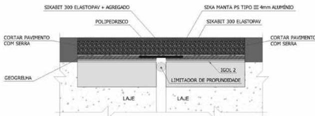
Aplicação de terceira camada de SikaBit®-300 ElastoPAV, a 180° C, com espessura variando entre 5 a 10 mm.
