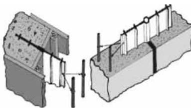
O recobrimento mínimo de concreto sobre o perfil deve ser a metade da largura do perfil.
